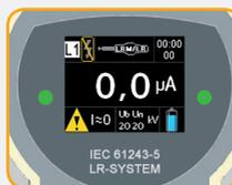
*Nach einer erfolgreichen Eigenprüfung wechselt das Gerät automatisch in den Messmodus für den Messkanal L1 und ist betriebsbereit.*
