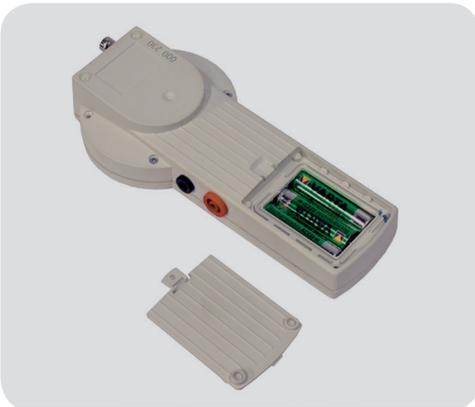
Nehmen Sie den Batteriedeckel ab. Entfernen Sie die alten Batterien und ersetzen Sie diese durch neue.
