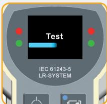
Während der Eigenprüfung leuchten 2 rote, 2 grüne LEDs neben dem Display und die blaue LED der Batteriestatusanzeige.
