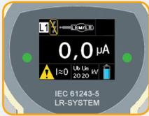
Entfernen Sie nach der Eigenprüfung die Messleitung und den LRM-Adapter aus den Prüfbuchsen.
