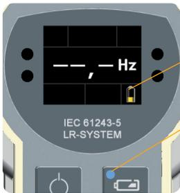
Blinkt die LED (1) für die Batteriestatusanzeige bzw. erscheint im Display ein gelbes Batteriesymbol (2), dann sollten Sie baldmöglichst einen Batteriewechsel durchführen (Batteriewechsel → Seite 48-49).
