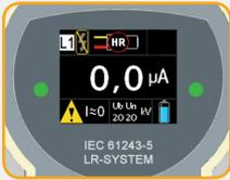
Entfernen Sie nach der Eigenprüfung die Messleitung und den HR-Adapter aus den Prüfbuchsen.
