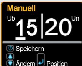
Stellen Sie den Wert für die Betriebsspannung Ub ein. Drücken Sie die Navigationstasten, bis der Wert erscheint.
