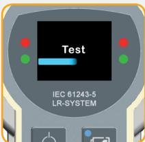
Während der Eigenprüfung leuchten 2 rote, 2 grüne LEDs neben dem Display und die blaue LED der Batteriestatusanzeige.
